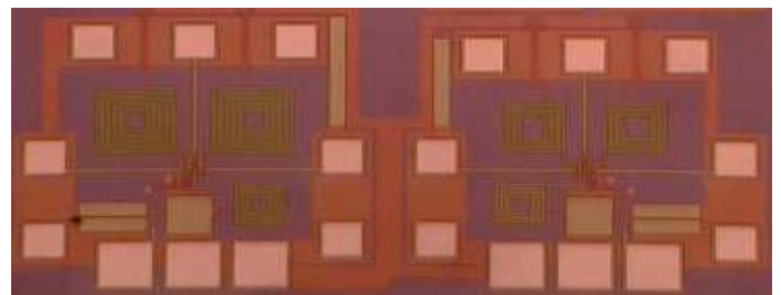
Figure 13 : CMOS – Diviseur de fréquence
